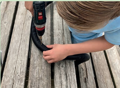
Foto 1: Zelf drainagebuizen maken.
